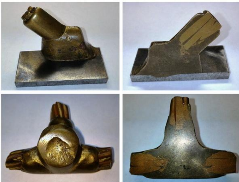
Рисунок 5. Образцы сварных соединений и их разрезы
