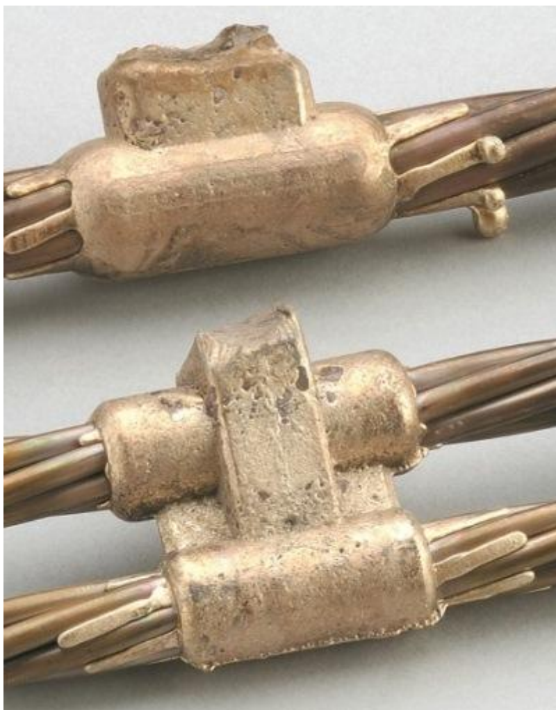
Рисунок 3. Пример использования термитной сварки для соединения проводников
