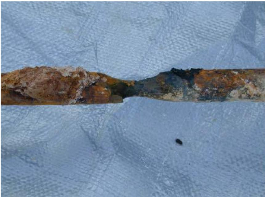
Рисунок 4. Производственный участок Равпі. Электрод типа І, находящийся рядом с оцинкованным электродом, извлеченный через 10 лет с момента монтажа.
