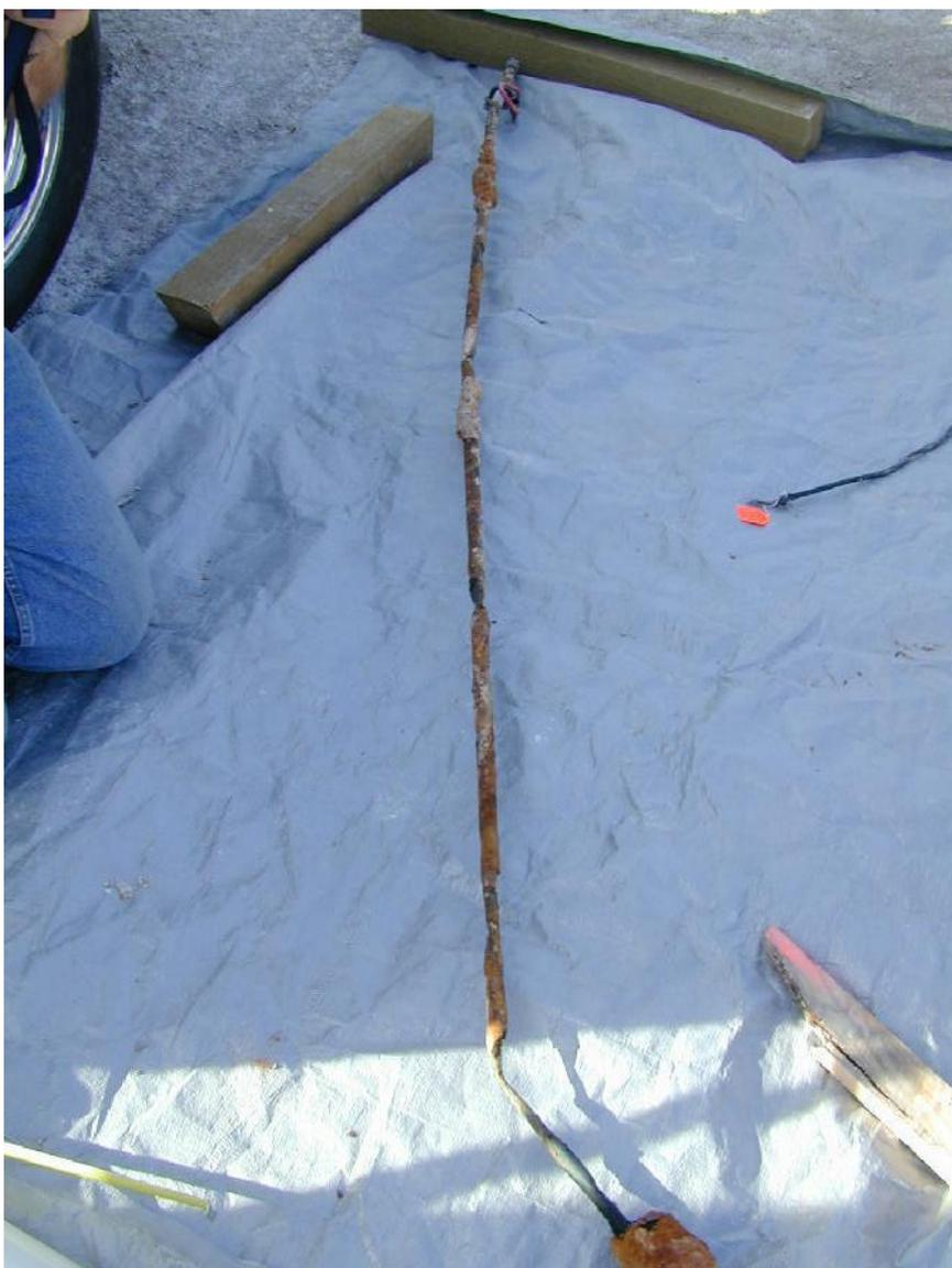
Рисунок 1. Производственный участок Ravni. Оцинкованный стержневой электрод длиной 3,04 м, извлеченный через 10 лет с момента монтажа.
