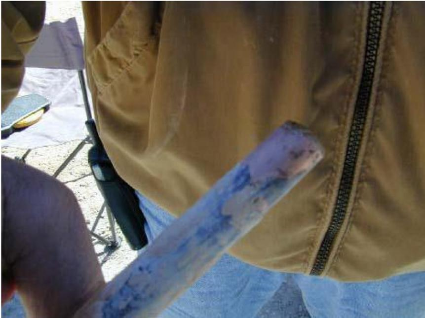
Рисунок 3. Производственный участок Равпі. Электрод типа Н, находящийся рядом с омедненным электродом, извлеченный через 10 лет с момента монтажа.
