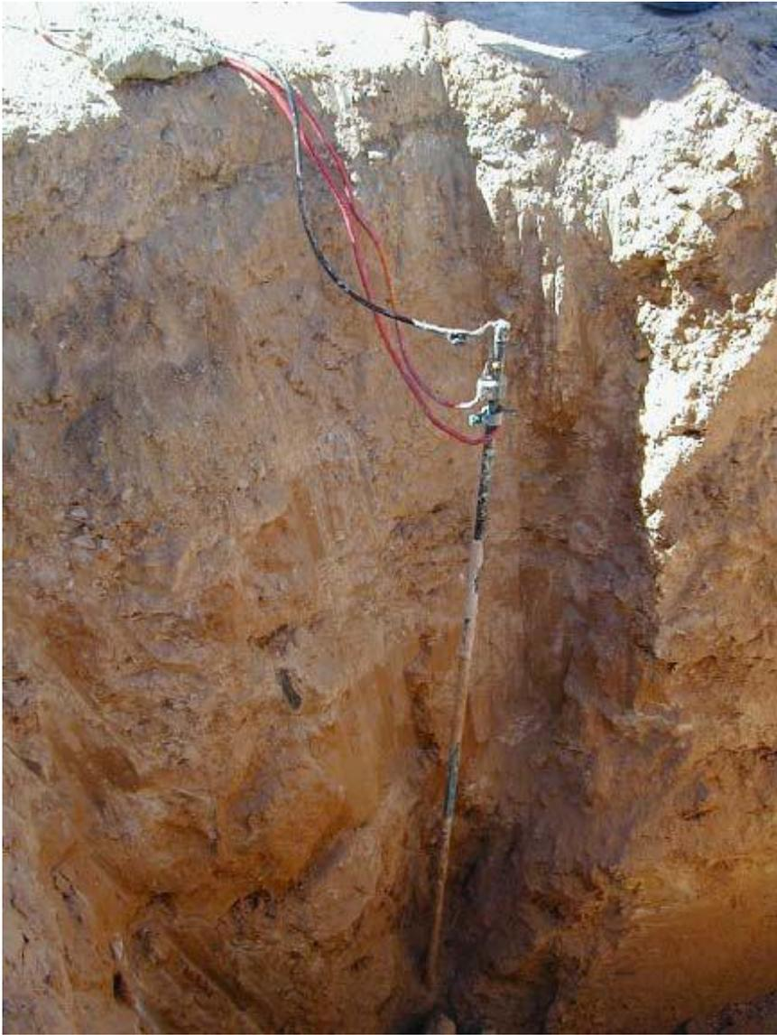
Рисунок 2. Производственный участок Равпі. Омедненный заземляющий электрод длиной 2,45 м, извлеченный через 10 лет с момента монтажа.
