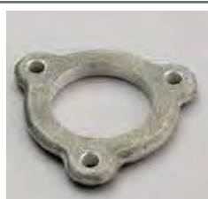
Кольцо для крепления оттяжек GUYRING (710280) 0.1 кг Для крепления оттяжек между мачтой FRP и молниеприемником.
