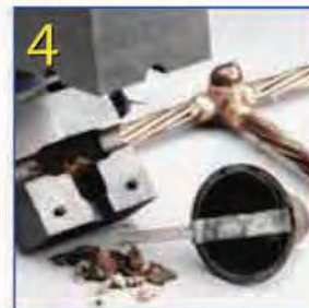
4 Откройте форму и извлеките использованный стальной стакан – специальные меры утилизации не требуются.
