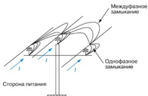
Рис. 2. Развитие процесса трехфазного короткого замыкания на ВЛ с изолированными проводами при ударе молнии.
