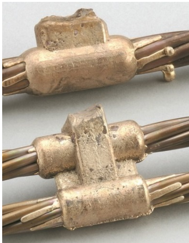
Рисунок 3. Пример использования термитной сварки для соединения проводников
