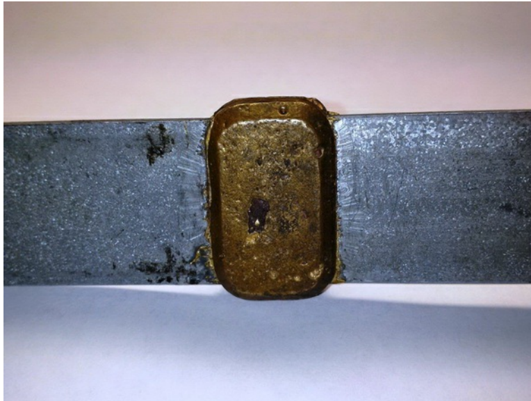
Рисунок 6. Образец сварного соединения встык стальной полосы с горячеоцинкованным покрытием
