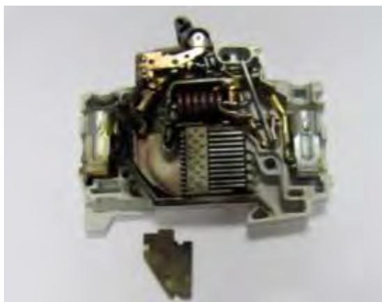
Рис. 1.7.4 Автоматический выключатель после нескольких воздействий импульсным током
