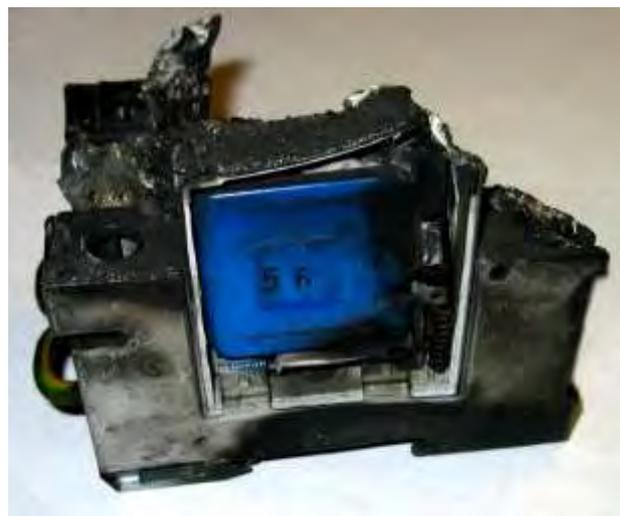
Рис. 1.6.1 Выход из строя варисторного УЗИП привел к пожару в РЩ.
