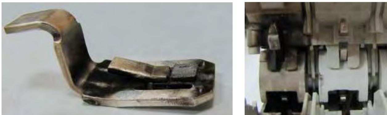
Рис. 1.7.5 Контакты автоматического выключателя после воздействия импульсного тока 20 кА (волны 10/350 мкс)
