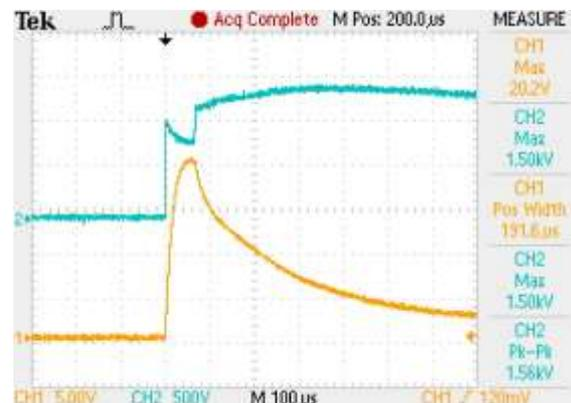
г)  $I_N = 100$  A gG, предохранитель сгорел через  $\approx 60$  мкс после начала импульса
