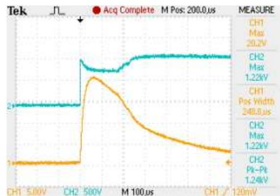
б)  $I_N = 160$  A gG, предохранитель сгорел через  $\approx 200$  мкс после начала импульса
