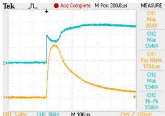
в)  $I_N = 125$  A gG, предохранитель сгорел через  $\approx 80$  мкс после начала импульса
